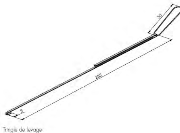
Figure N°2 bis : tringle de levage
