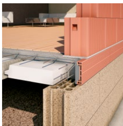
Plancher bas sur vide sanitaire avec hourdis isolant
